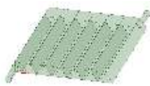
Gambar 2. Pemodelan geometri kolektor dengan 7 saluran segitiga zig-zag
