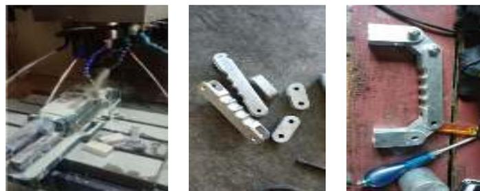
**Gambar 5.** Komponen Hasil Pemesinan CNC Milling
