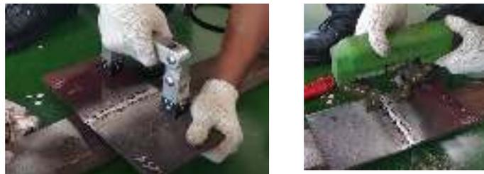
**Gambar 6.** Pengujian *Permanent Magnetic Yoke* dan Yoke DC
