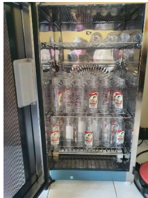
Gambar 5. Sterilisasi Botol Kemasan Susu Sapi alat sterilisasi sinar UV C portable
