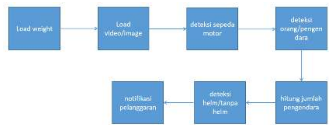
Gambar 2. Blok diagram deteksi pelanggaran
